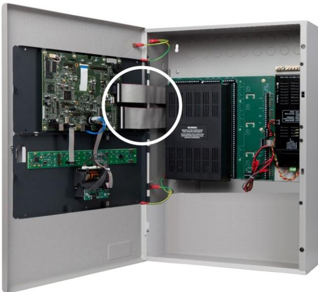
3. Retire los pasadores de las bisagras de la pantalla de control y luego retírelo de la caja del gabinete. Vuelva a colocar los pasadores en las bisagras de la caja del gabinete para guardarlos.
