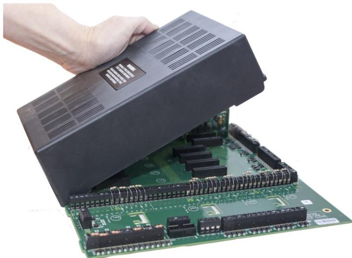
3. Retire el módulo del embalaje protector utilizando una protección electrostática adecuada.
